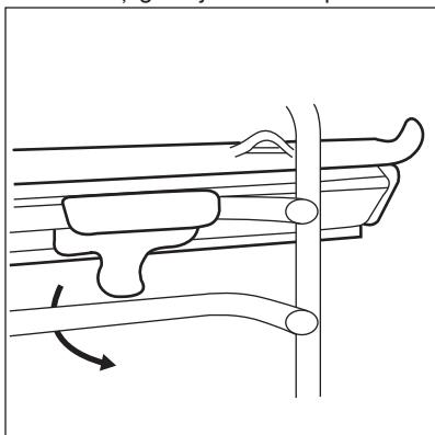
2. Elementul opritor (A) care se află la un capăt al ghidajului telescopic trebuie să fie îndreptat în sus.
