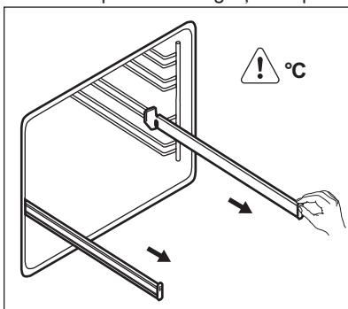
2. Puneti grătarul pe ghidajele telescopice, apoi împingeți-l cu atenție în interiorul aparatului.
