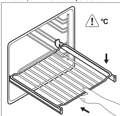
Înainte de a închide uşa cuporului, verificați dacă ați împins ghidajele telescopice complet în aparat.
